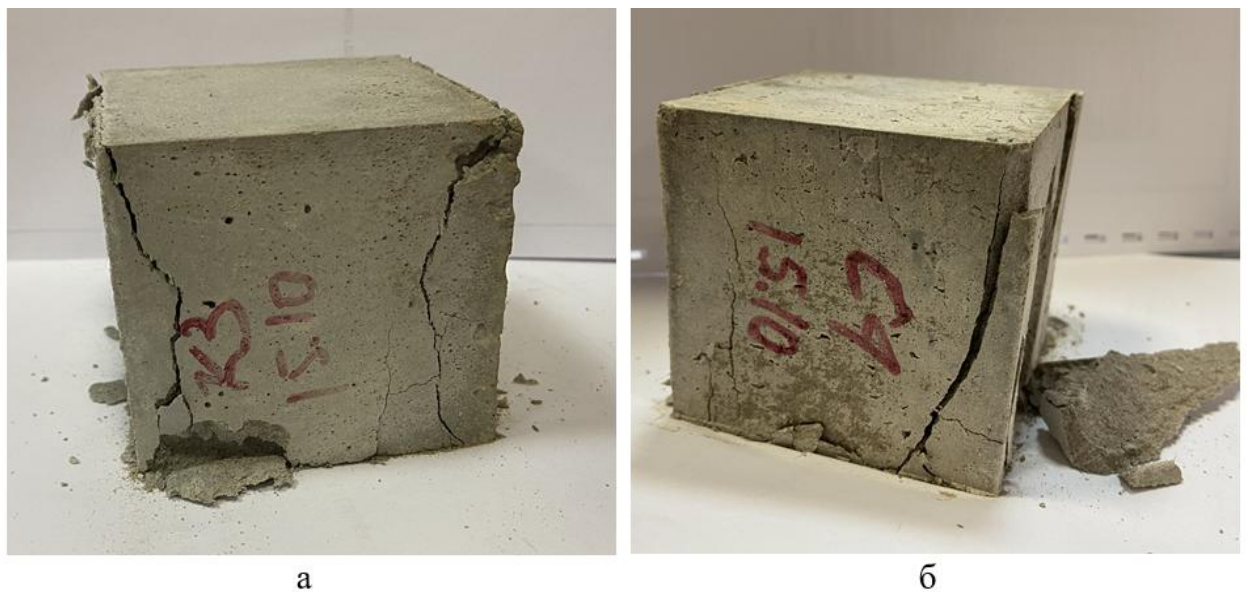
Рисунок 5.5.4 – Испытание образцов мелкозернистого бетона на прочность при сжатии: а) состав бетона без МСП; б) состав бетона с МСП
