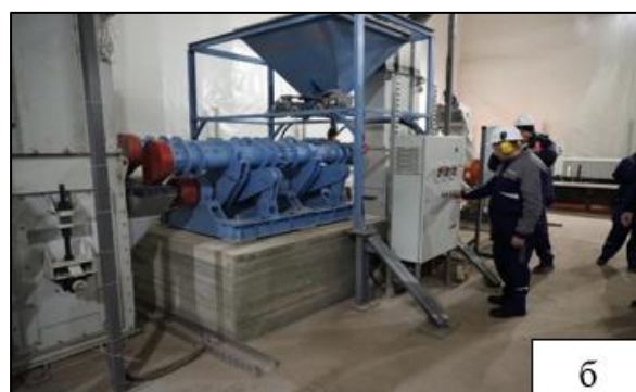
Рисунок 8.2.3 - Промышленная установка получения минерального порошка: а – общий вид; б – узел механоактивации
