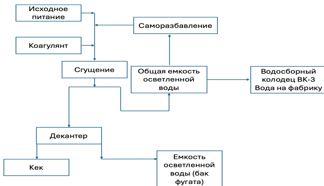
Рисунок 8.1.2 - Принципиальная технологическая схема опытно-промышленного узла получения осветленной воды и сгущенного продукта (кека)
