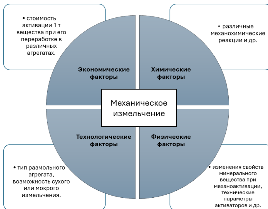
Рисунок 1.6.1 – Факторы, влияющие на эффективность механического измельчения (механоактивации)
