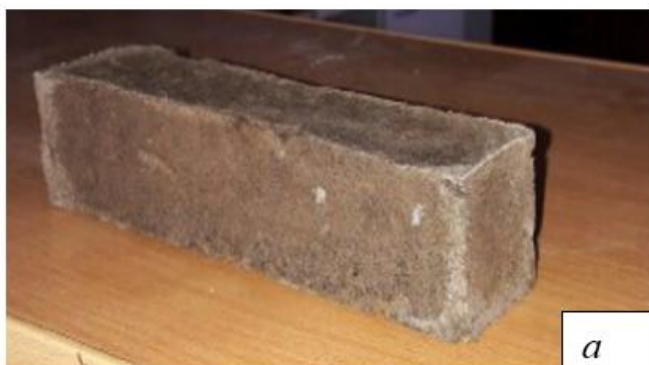
Рисунок 6.3.4.2 – Опытный образец (85% базальт; 15 % МСП)
