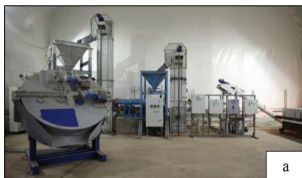
Рисунок 8.2.3 - Промышленная установка получения минерального порошка: а – общий вид; б – узел механоактивации
