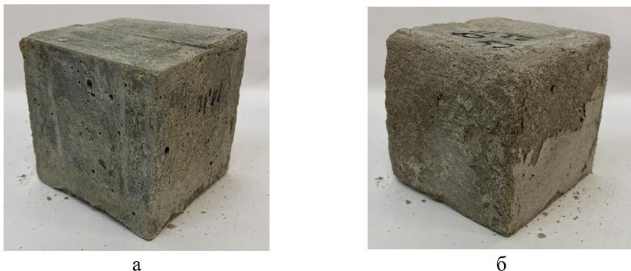
Рисунок 5.5.5 – Испытание образцов мелкозернистого бетона на морозостойкость (100 циклов замораживания-оттаивания): а) состав бетона с МСП; б) состав бетона без МСП
